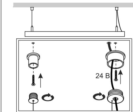
**3** Вкрутите крепёжный винт в подвес, оставив небольшое пространство [1]. Затем проденьте нижнюю часть подвеса в установочное отверстие профиля [2].
