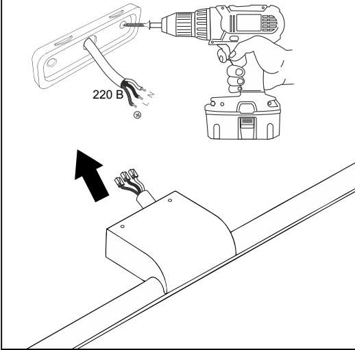
**!** Установка светильника осуществляется при выключеной электрической сети.
