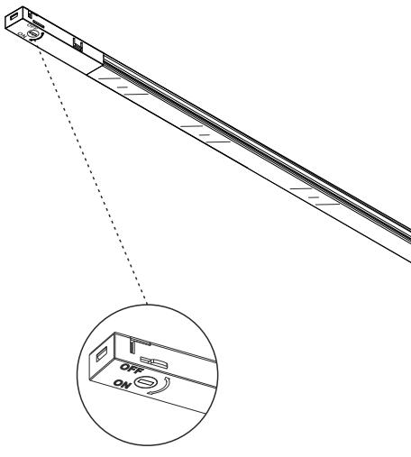
**2** Установите светильник в шинопровод до щелчка
