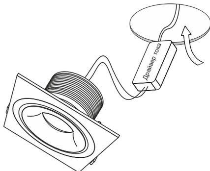
**5** Поднимите клипсы [1] и установите светильник в отверстие [2].
