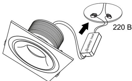
**!** Установка светильника осуществляется при выключенной электрической сети.
