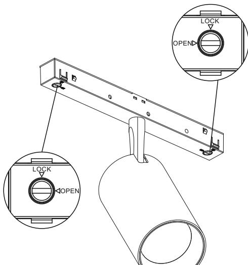
**2** Установите светильник в шинопровод до щелчка
