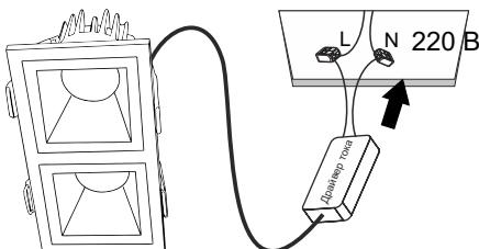
**!** Установка светильника осуществляется при выключеной электрической сети.
