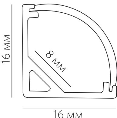
Комплект углового алюминиевого профиля LINEAR 1616 U предназначен для декоративной подсветки при помощи интеграции в него светодиодной ленты.
