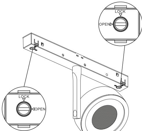
**2** Установите светильник в шинопровод до щелчка
