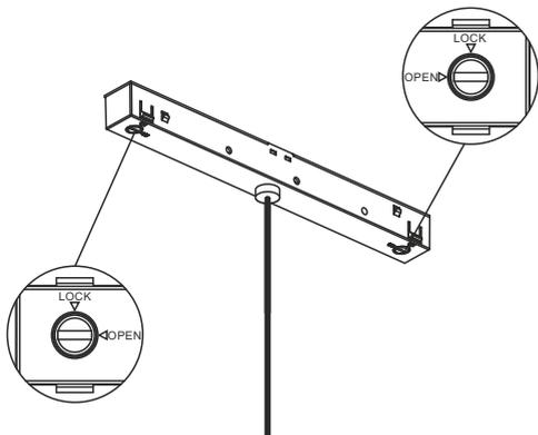
**2** Установите адаптер светильника в шинопровод до щелчка
