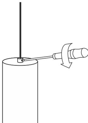
**5** Отрегулируйте высоту светильника [1], затяните фиксирующий винт [2].
