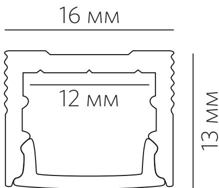
Комплект накладного алюминиевого профиля LINEAR 1613 N предназначен для декоративной подсветки при помощи интеграции в него светодиодной ленты.
