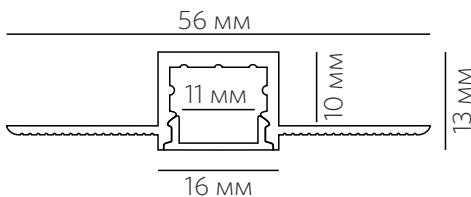
Комплект алюминиевого профиля LINEAR 1613 F предназначен для освещения при помощи интеграции в него светодиодной ленты.
