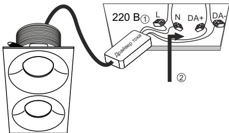
! Установка светильника осуществляется при выключеной электрической сети.
