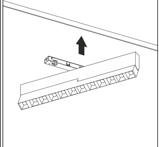
**3** Переведите фиксатор на адаптере светильника в положение «ON»
