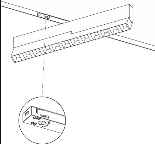
**4** Установка завершена, светильник готов к эксплуатации.
