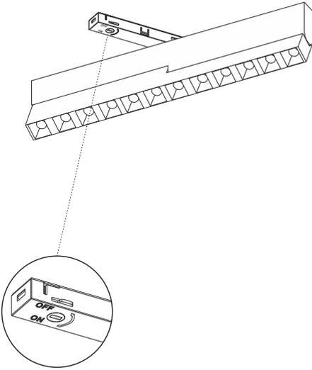
**2** Установите светильник в шинопровод до щелчка
