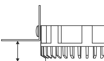
Установите монтажное основание в отверстие и закрепите саморезами.
