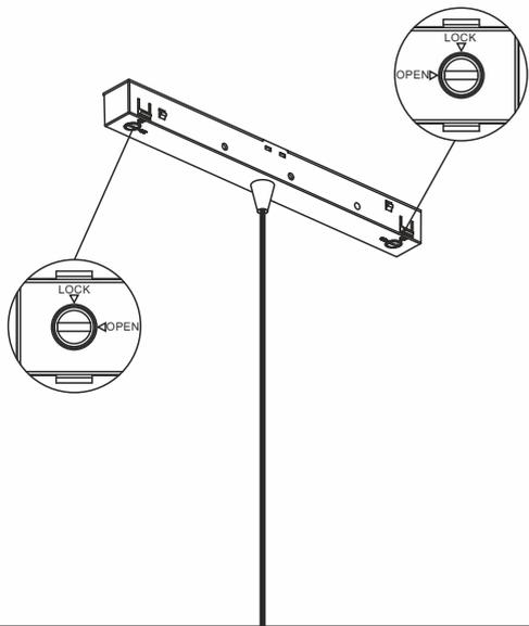
**2** Установите адаптер светильника в шинпровод до щелчка
