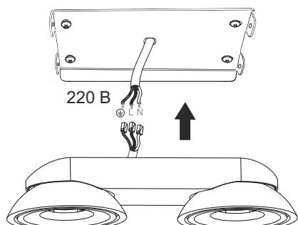
**!** Установка светильника осуществляется при выключеной электрической сети.
