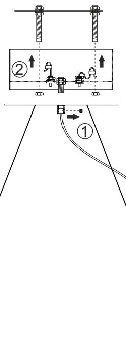
2 Установите крепление на потолке рядом с кабелем питания.
