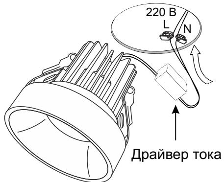
**!** Установка светильника осуществляется при выключеной электрической сети.
