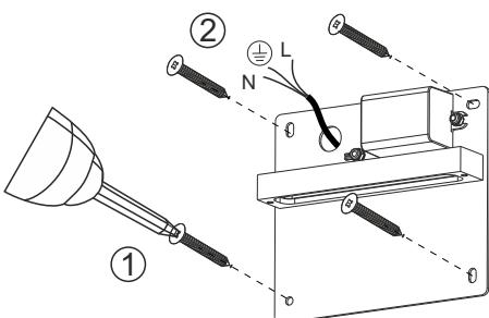
**4** Подключите светильник к сети 220 В с помощью термоусадочных клемм.
