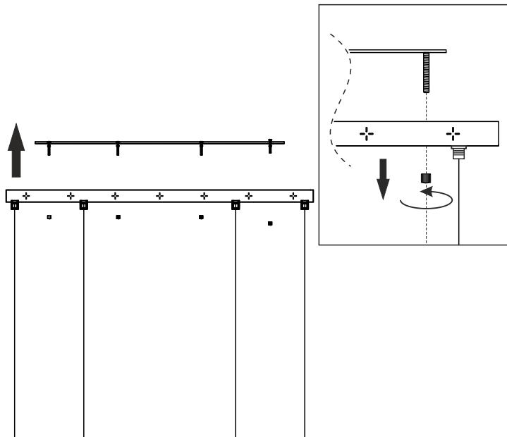
2 Установите крепление на потолке рядом с кабелем питания.
