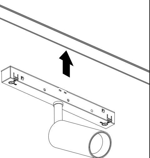
**3** Переведите фиксаторы на адаптере светильника в положение «Lock»
