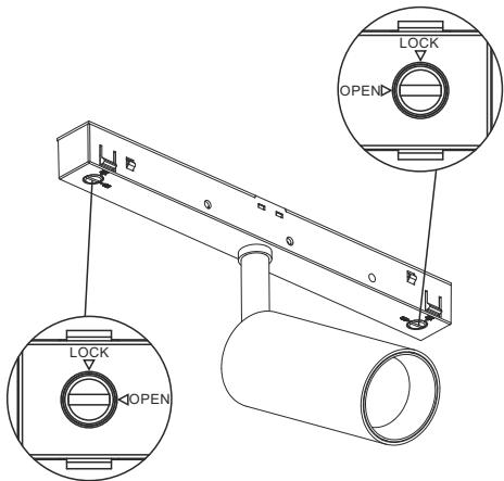
**2** Установите светильник в шинопровод до щелчка
