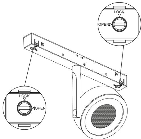
**2** Установите светильник в шинопровод до щелчка
