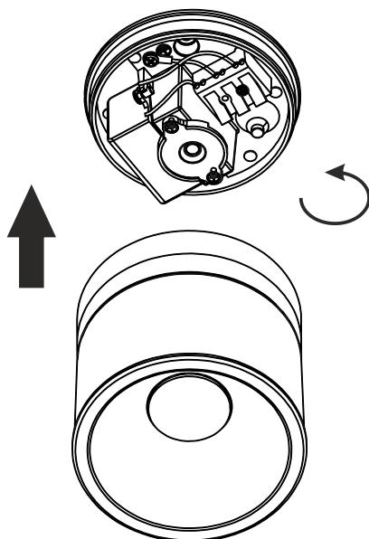
**3** Выведите провод питания через соответствующее отверстие [1]. Закрепите основание светильника [2]. Подключите светильник в сеть 220 В [3].
