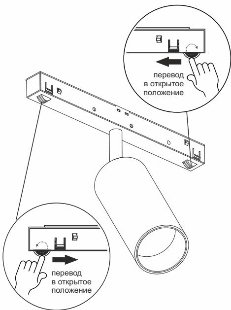
**2** Установите светильник в шинопровод до щелчка
