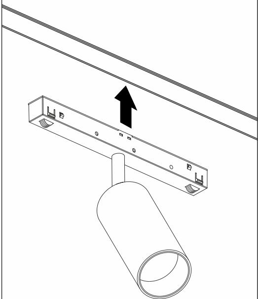
**3** Переведите фиксаторы на адаптере светильника в закрытое положение
