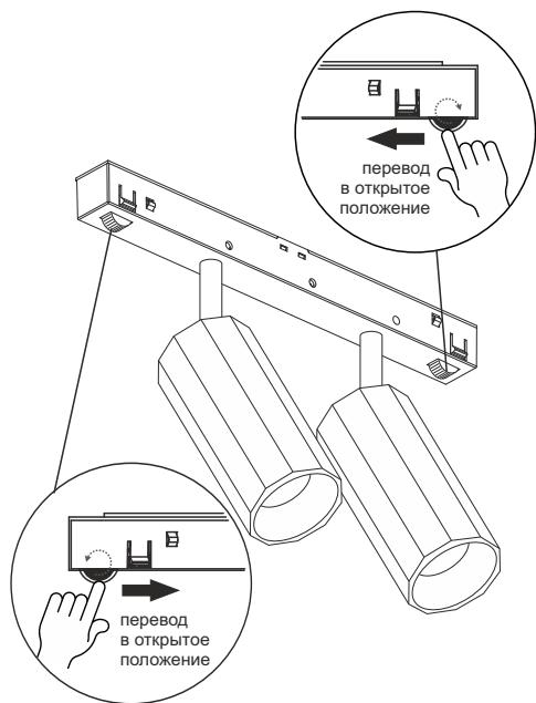
**2** Установите светильник в шинопровод до щелчка
