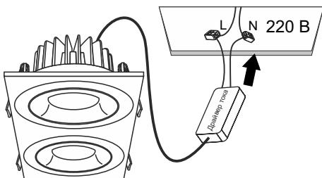
! Установка светильника осуществляется при выключеной электрической сети.
