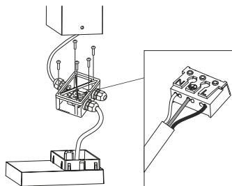
Установка светильника осуществляется при выключеной электрической сети.
