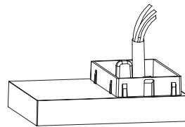
**3** Закрепите основание на поверхности пола.
