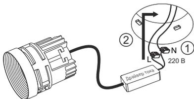
**6** Установите светильник в монтажное основание [1] и зафиксируйте, повернув по часовой стрелке [2].
