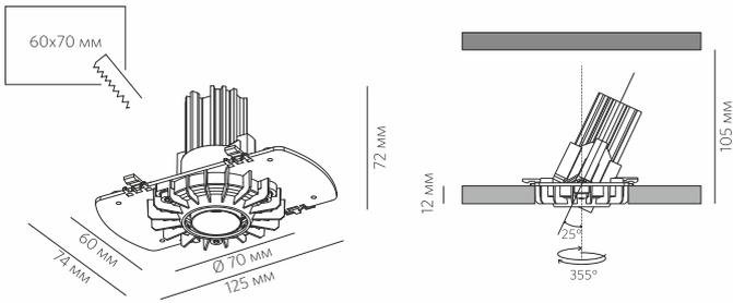
Размеры врезных отверстий для установки монтажных оснований в поверхность из гипсокартона
