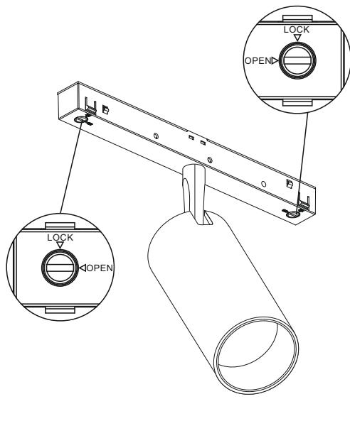
**2** Установите светильник в шинопровод до щелчка
