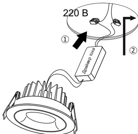
**!** Установка светильника осуществляется при выключенной электрической сети.
