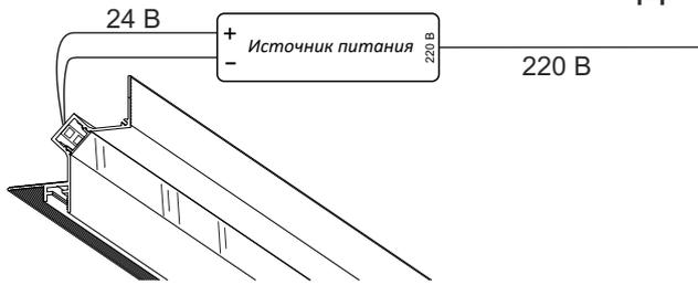
Источник питания устанавливается за пределами корпуса профиля в электромонтажном шкафу
