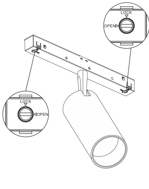
**2** Установите светильник в шинопровод до щелчка
