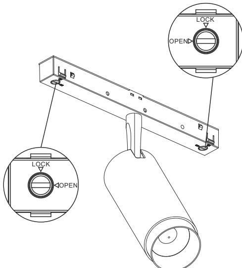
**2** Установите светильник в шинопровод до щелчка
