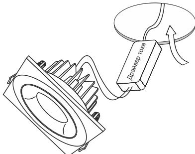
**6** Установка завершена, светильник готов к эксплуатации.
