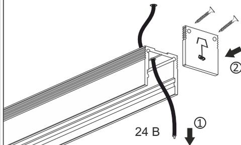
**3** Установите корпус на потолок при помощи саморезов.
