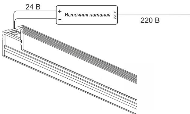
Источник питания устанавливается за пределами корпуса профиля в электромонтажном шкафу, или за потолочным пространством
