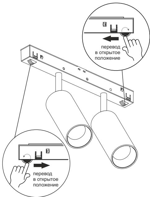
**2** Установите светильник в шинопровод до щелчка
