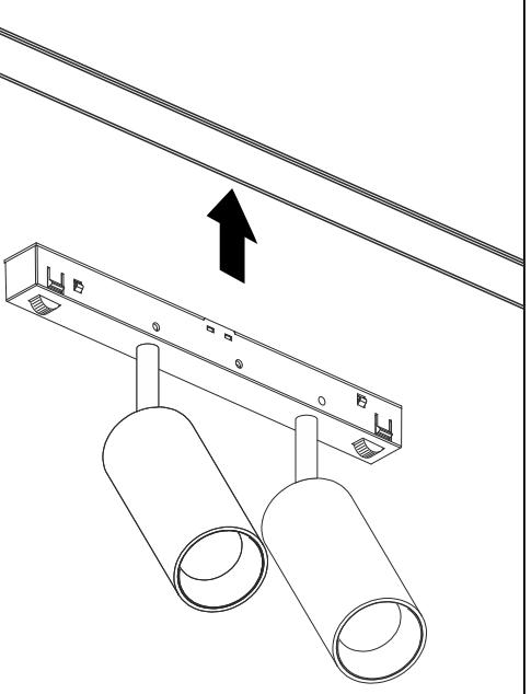
**3** Переведите фиксаторы на адаптере светильника в закрытое положение
