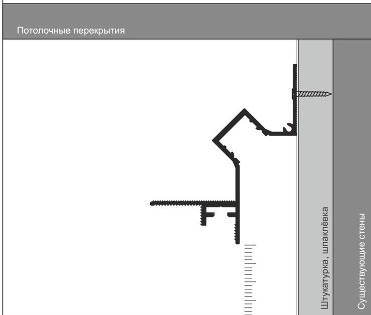
**2** Установите металлический каркас потолка. Закрепите теневой профиль на металлическом каркасе.
