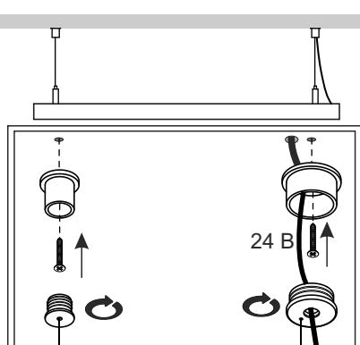
3 Вкрутите крепёжный винт в подвес, оставив небольшое пространство [1]. Затем продените нижнюю часть подвеса в установочное отверстие профиля [2].
