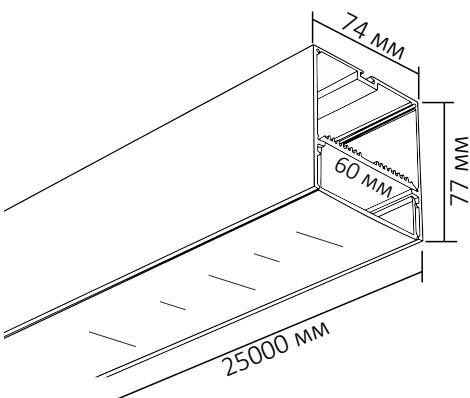
Комплект алюминиевого профиля LINEAR 7477 N предназначен для освещения при помощи интеграции в него светодиодной ленты.
