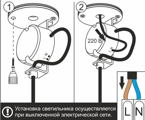
3 Вкрутите потолочную базу в основание [1]. Установка завершена, светильник готов к эксплуатации [2].
