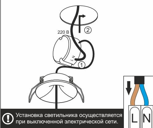
3 Поднимите клипсы и установите светильник в отверстие [1]. Установка завершена, светильник готов к эксплуатации [2].
