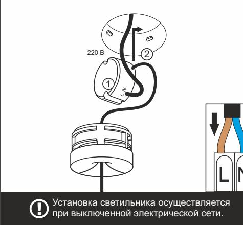
4 Ослабьте фиксатор и отрегулируйте высоту подвеса [1]. Установите базу в монтажное основание и зафиксируйте, повернув по часовой стрелке [2].
