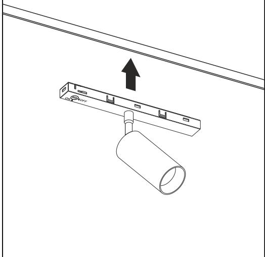
**3** Переведите фиксатор на адаптере светильника в положение «ON»
