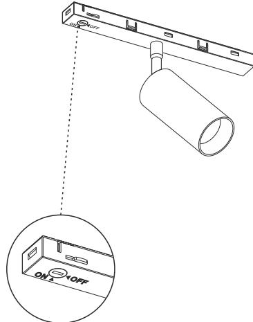
**2** Установите светильник в шинопровод до щелчка
