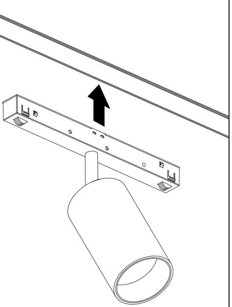
**3** Переведите фиксаторы на адаптере светильника в закрытое положение
