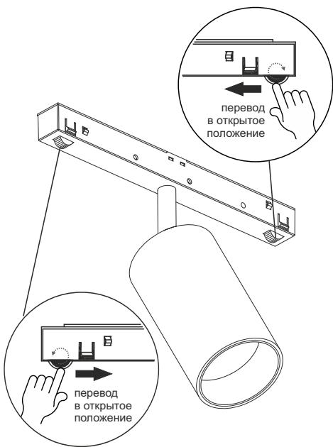
**2** Установите светильник в шинопровод до щелчка
