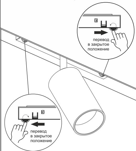
**4** Установка завершена, светильник готов к эксплуатации.
