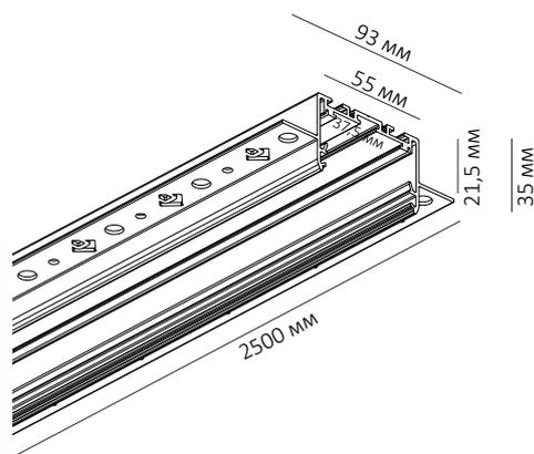
Алюминиевый профиль LINEAR 5535 F B предназначен для освещения при помощи интеграции в него светодиодной ленты.
