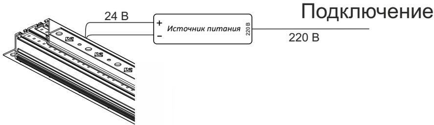
Источник питания устанавливается за пределами корпуса профиля в электромонтажном шкафу
