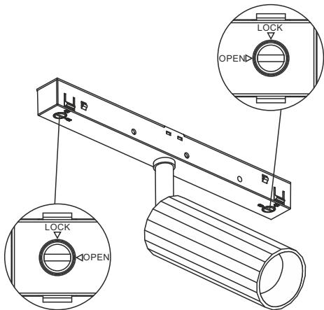
**2** Установите светильник в шинопровод до щелчка
