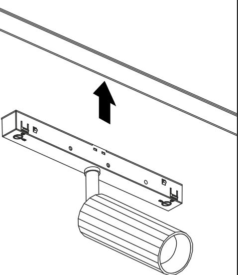
**3** Переведите фиксаторы на адаптере светильника в положение «Lock»
