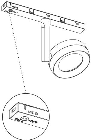
**2** Установите светильник в шинопровод до щелчка
