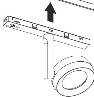
**3** Переведите фиксатор на адаптере светильника в положение «ON»
