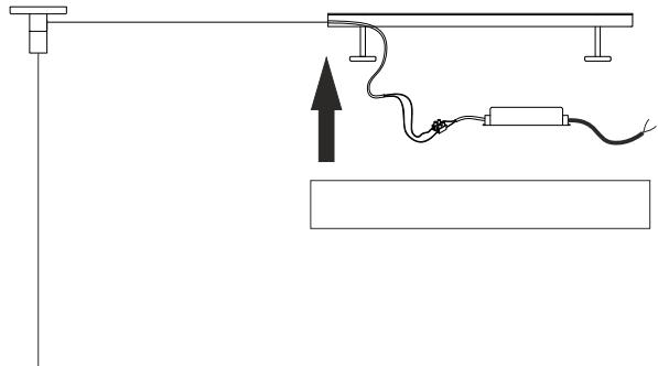
2 Установите крепление на потолке рядом с кабелем питания.
