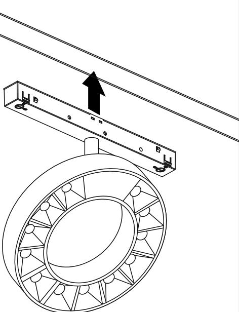
**3** Переведите фиксаторы на адаптере светильника в положение «Lock»
