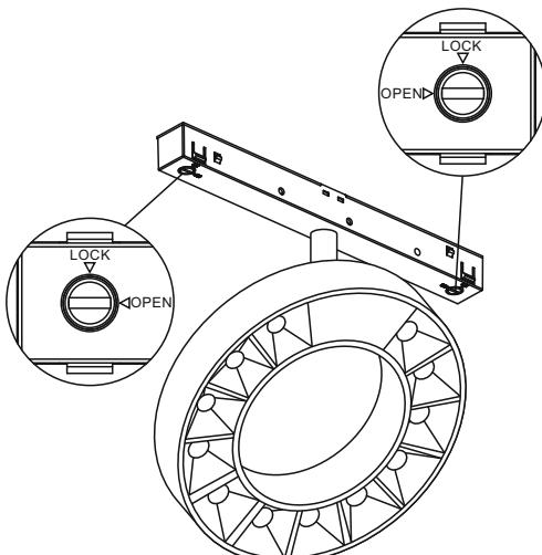
**2** Установите светильник в шинопровод до щелчка
