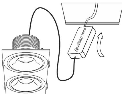
**5** Поднимите клипсы [1] и установите светильник в отверстие [2].
