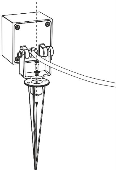
**2** Подключите светильник к сети 220 В с помощью герметичного коннектора.
