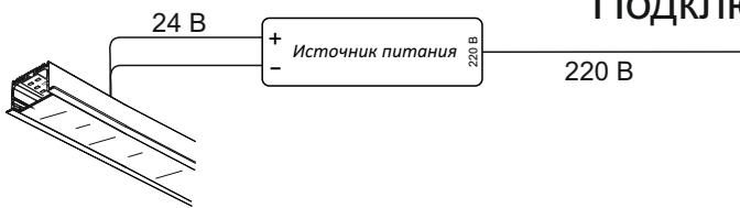
Источник питания устанавливается за пределами корпуса профиля в электромонтажном шкафу, или за потолочным пространством
